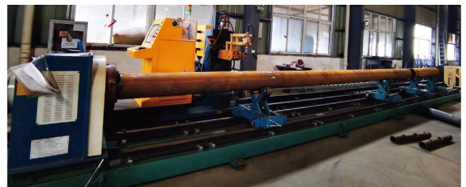
数控5轴相贯线切割机机器人 CNC 5-axis intersecting wire cutting robot
